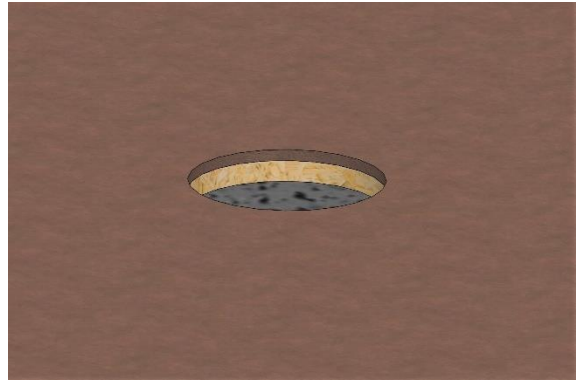
Bohren eines Loches mit 150mm Durchmesser
