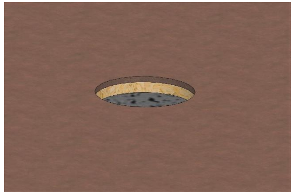
Bohren eines Loches mit 150mm Durchmesser
