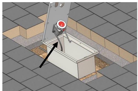
Kabel in die Box legen
