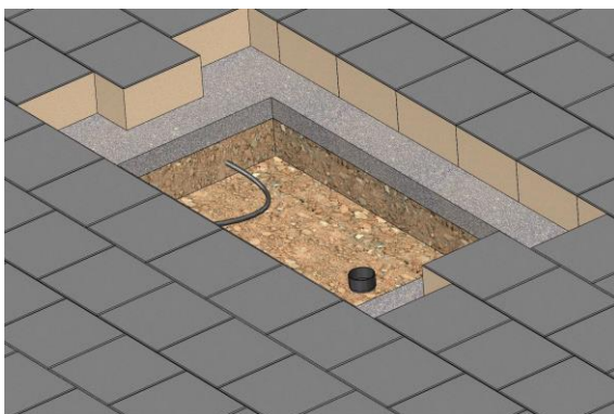
Steine herausnehmen und ein Loch graben (ca. 240 mm tief ab Steinoberfläche)
