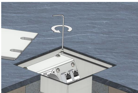
Deckel kann nach oben feinjustiert werden
