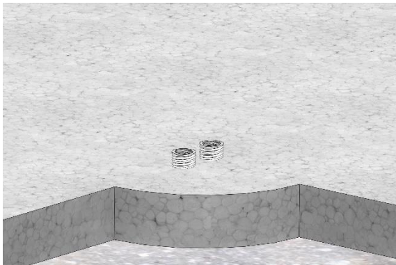
Die Kabel können seitlich oder von unten zugeführt werden (Darstellung: unten)
