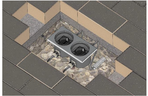
Kabel anschließen Geräteträger einschrauben
