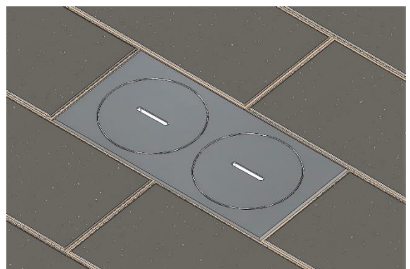
Restliche Steine einsetzen
