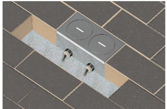
Pflastersteine einsetzen (teilweise im Mörtel) Steine an Kabelverschlüsse anpassen
