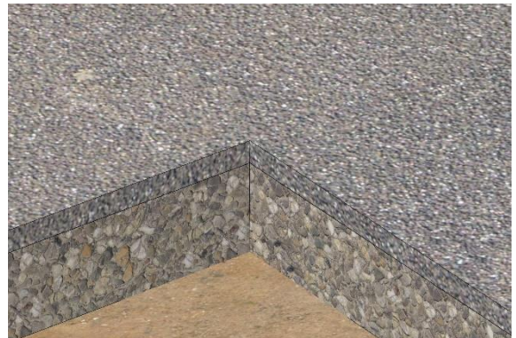
Gesamte Fläche zum Pflastern vorbereiten Die Stelle der Kabel merken
